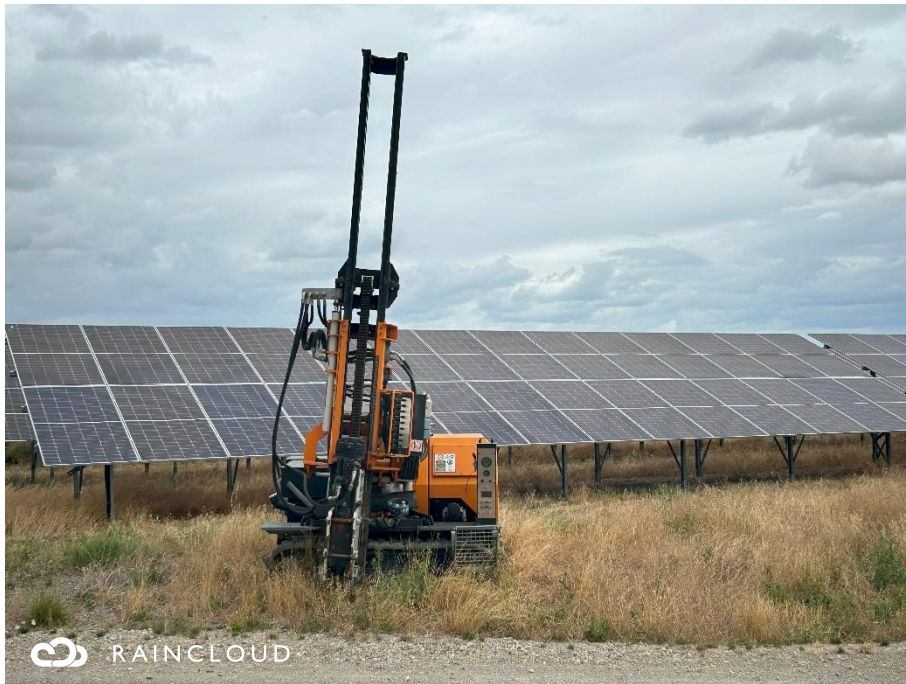
Plate 12-23 Mini pile driver examples
